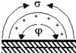
Рис. 1. Действие сил поверхностного натяжения и электрических сил на поверхность
