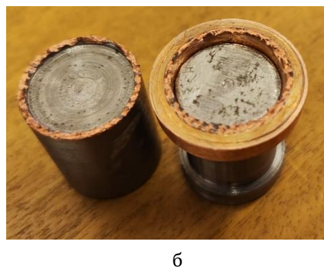
Рис. 4. Схема испытаний прочности соединения слоёв на отрыв плакирующего слоя (а) и образец сталь-медь после испытаний на отрыв плакирующего слоя (б):
