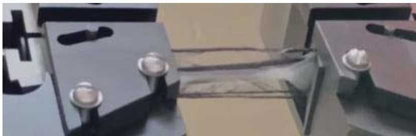
Рис. 2. Разрушение АрПКМ образца на основе СБС с заполнением 40 %
