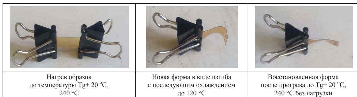
Рис. 2. Наглядный опыт U-shape bending test для ПЭИ
